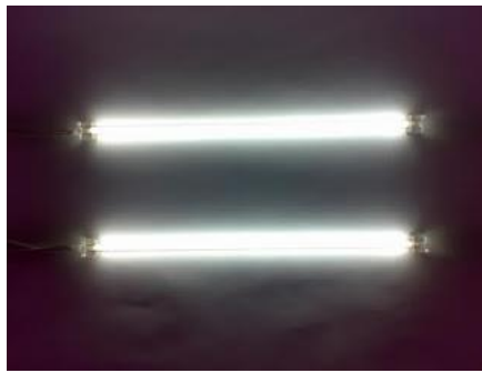
Gb. 5 Lampu neon putih panjang pada meja cetak sablon (gambar tampak atas)
